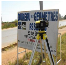
Le niveau automatique en station
